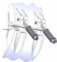
Beispiel 4 / example 4 Federn einseitig, klappbar one-sided springs, hingeable
