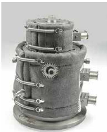
Werkzeug mit Isolation, nachher tool with insulation, after
