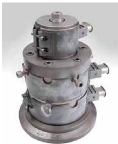
Werkzeug ohne Isolation, vorher tool without insulation, before
